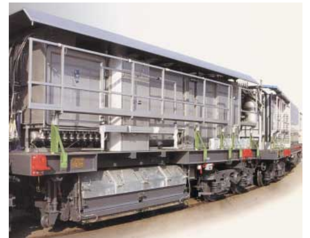
Geöffnete Seite eines Schleifmoduls mit den Leistungsteilen und dem Staubsauger oben sowie der Schleifeinheit unter dem Wagenkasten.
