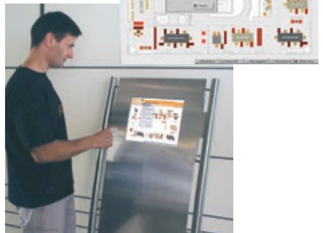
Bildschirmdarstellung am Eingang jedes Stockwerkes auf dem Touch Screen PC unter Saia®ViSi-PLUS. Nach Wahl der Bürozone erscheint das entsprechende Bedienfeld für Licht und Storen
