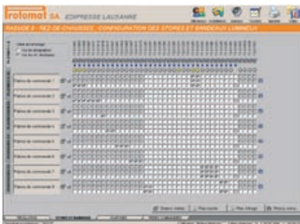
Konfigurations-Beispiel zur Zonenregelung. Mit einem Mausklick kann in dieser Matrix ein beliebiges Sensor einer Zone mit einem Aktor, z.B. einem Ventil, verknüpft werden
